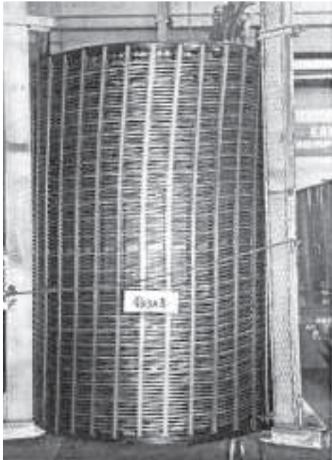
Рис. 17. Вид обмотки НН трансформатора мощностью 400 МВ·А, поврежденной («повернутой») тангенциальными силами КЗ
