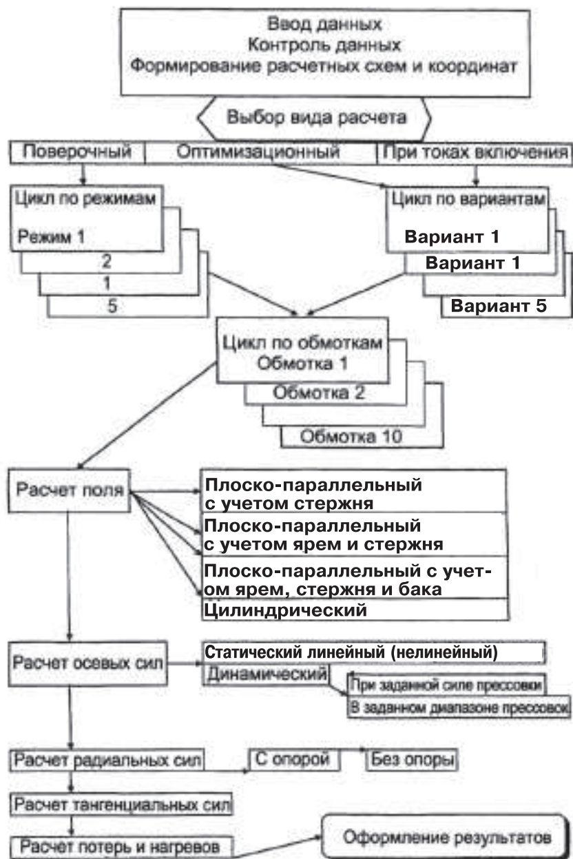
Рис. 23. Укрупненная блок-схема пакета программ РЭСТ (расчет электродинамической стойкости трансформаторов)
